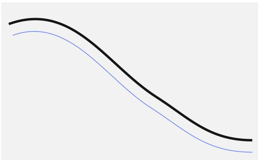
**Beispiel Konturbahn innen (ohne/mit Anzeige Werkzeugdurchmesser)**
