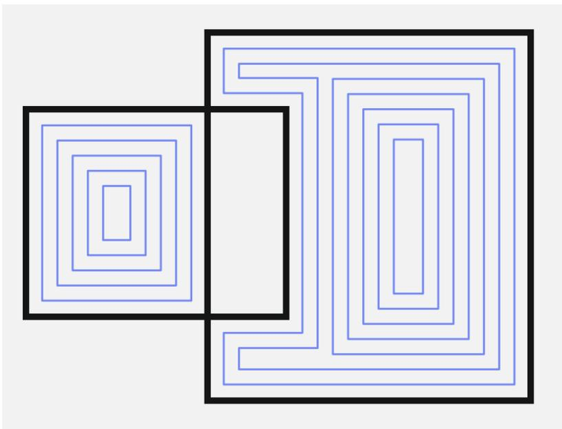
Hier sind mehr als zwei Rechtecke miteinander kombiniert. CamDRAW erstellt die entsprechende Taschenbahn, damit Ihre CNC-Maschine das Material herausholen kann. Beispiel ohne und mit Anzeige des Werkzeugdurchmessers. Die Anzeige des Werkzeugdurchmessers ist eine gute Möglichkeit zur Kontrolle, wo und wieviel Material herausgeholt wird. Zudem können Sie feststellen, ob irgendwo Material übrigbleibt. Hier z.B. in den Ecken (Radius des Fräswerkzeugs).
